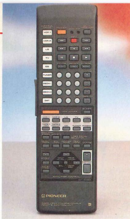
Il telecomando in dotazione all'amplificatore audio/video Pioneer VSA-D802S è anche programmabile per un totale che può andare da un minimo di 50 ad un massimo di 100 funzioni, a seconda della complessità dei codici «insegnati».
